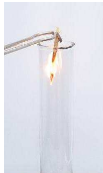
Verbrennung unter Flammeneerscheinung in reinem Sauerstoff
