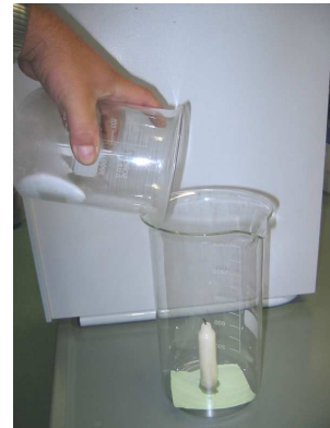
mittels CO 2 gelöschte Kerze im Becherglas
