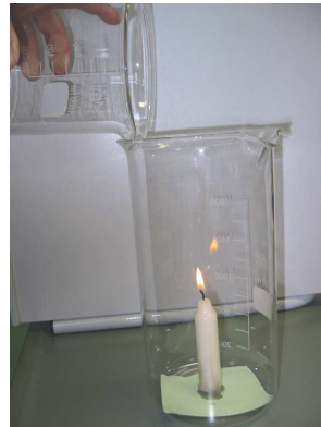
Löschmittel CO 2 wird eingefüllt
