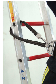
Eigensicherung mit Feuerwehrhaltegurt
