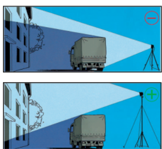
Hoch angeordnete Lichtquellen verringern die Schattenbildung
